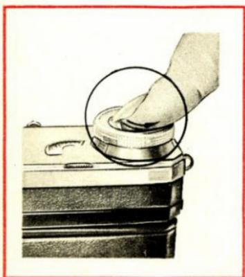
Рис. 23. Взвод рычага автоспуска.
